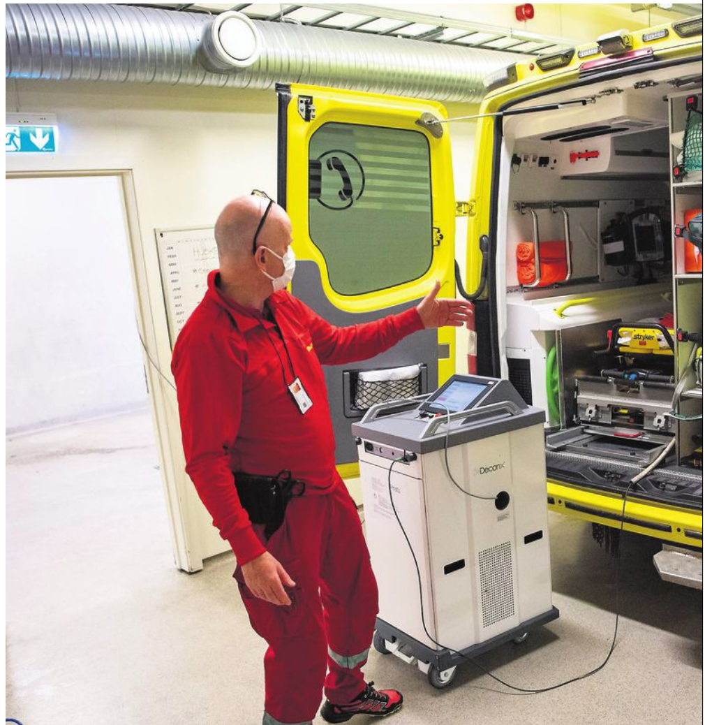
SMITTEVERNROBOT: Gassen som kommer ut fra denne roboten dreper alt av virus og bakterier, og kommer til i alle kroker og kroker. - Roboten er et viktig som er ansvarlig for smittevern ved ambulansesasjonen i Godvik.
