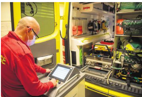
MELLOM EN OG TRE TIMER: Maskinen kobles opp, og justeres etter hvilken biltype den skal desinfisere. Når dørene lukkes, sprøytes gassen inn i bilen. Prosessen tar mellom en og tre timer.
